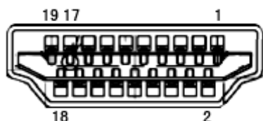
19-контактный кабель для передачи сигналов цветного изображения
