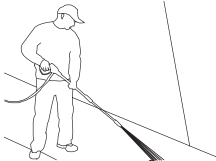
Рис. 4 - Оптимальный угол для распыления воды с очищаемой поверхности 45°
