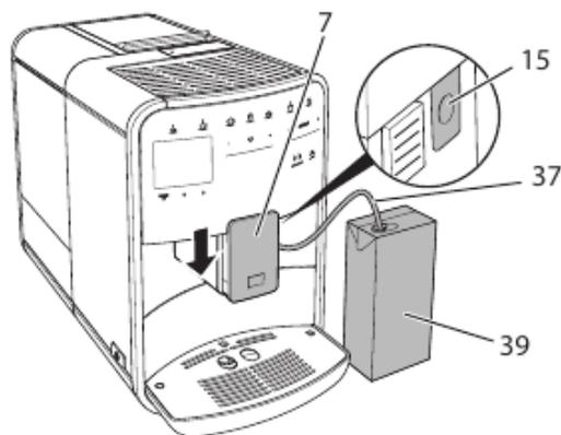
Рис. 14: Подключение трубки для молока к аппарату
