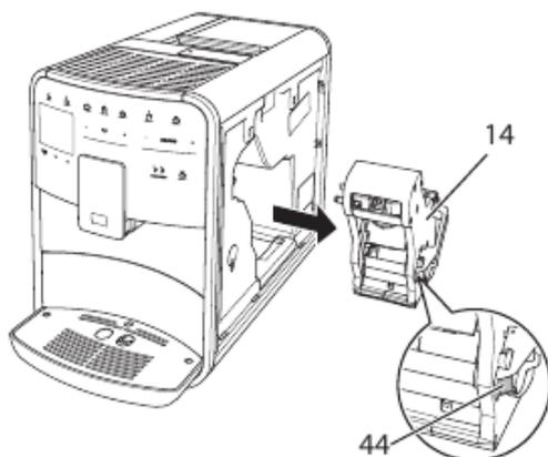
Рис. 21: Демонтаж блока заваривания, 2
