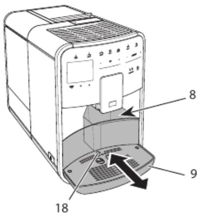
Рис. 15: Поддон для сбора капель, емкость для кофейного жмыха и поплавки
