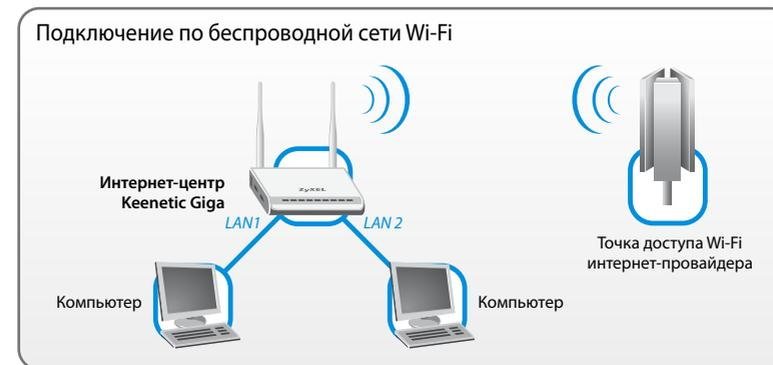
Оптимальное расположение интернет-центра для приема сигнала Wi-Fi определяется опытным путем. По возможности установите его вблизи окна, так чтобы никакие токопроводящие предметы, например металлические решетки в оконных проемах, металлизированные пластмассы и пленки, не загромождали открытое пространство перед интернет-центром и не ослабляли беспроводной сигнал. Следите, чтобы интернет-центр не попадал под воздействие прямых солнечных лучей и дождя.
