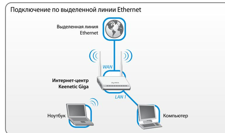
Для организации домашней сети вы можете использовать встроенную точку доступа Wi-Fi и четыре разъема «LAN». Все подключаемые устройства должны быть оборудованы сетевым адаптером Wi-Fi или Ethernet. Интернет-центр по протоколу DHCP автоматически назначит им параметры IP. Общие рекомендации по работе в беспроводной сети приведены на *стр. 22*.
