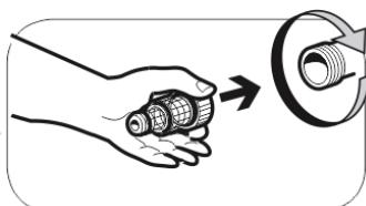
На резьбу входного патрубка **с лицевой стороны** корпуса мойки прикрутите фильтр тонкой очистки с ниппелем быстросъемного соединителя.
