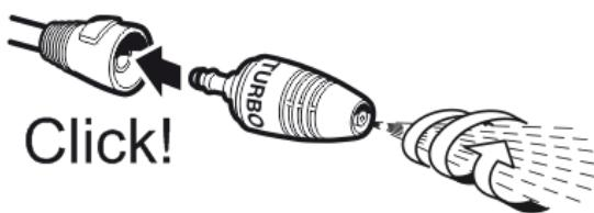
Установите головку роторной форсунки TURBO в удлинительную насадку. Головка фиксируется быстросъемным соединением. Для того, чтобы извлечь головку, нажмите на кнопку и достаньте головку.
