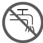
Согласно действующим предписаниям устройство запрещается подключать непосредственно к коммунальной хозяйственно-питьевой системе без системного разделителя в трубопроводе. Убедитесь, что подключение к домовой сети водопровода, к которому подсоединен моющий аппарат высокого давления, оснащено обратным клапаном в соответствии с EN 12729, тип ВА. Вода, прошедшая через системный разделитель, считается непригодной для питья.
