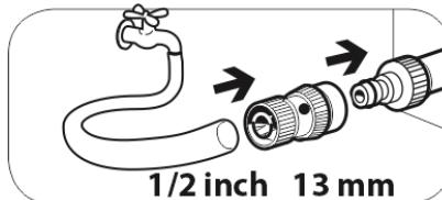
Для подключения мойки к водопроводной сети можно использовать поливочный шланг диаметром не менее 1/2 дюйма (допускается использовать шланги диаметром 5/8 и 3/4 дюйма).
