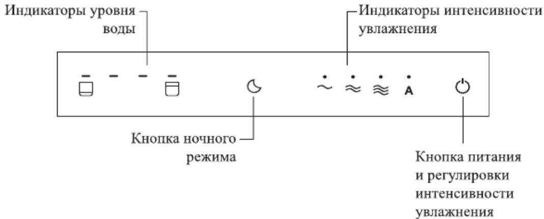
⏻ — кнопка питания и регулировки интенсивности увлажнения. Кратковременное нажатие на кнопку включает устройство. Чтобы выключить мойку воздуха, удерживайте кнопку в течение 3 секунд. При нажатии на кнопку раздается короткий звуковой сигнал.
