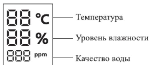
В корпус мойки воздуха встроены датчики температуры, уровня влажности (гигрометр), качества и уровня воды. Дисплей на лицевой панели выводит показания температуры, уровня влажности и качества воды.
