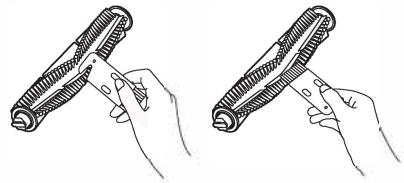
(3) Установите основную щетку и крышку главной щетки и зафиксируйте зажим.
