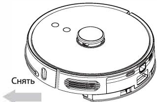
(2) Нажмите кнопку Отсек пылесборника, чтобы снять пылесборник 2-в-1 с резервуаром для воды.
