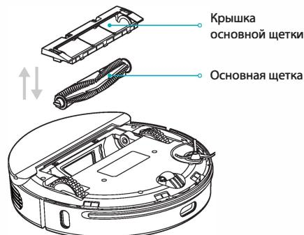
(2) Срежьте волосы вокруг щетки ножом и очистите основную щетку другим концом ножа.
