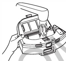
(6) Переверните бак и снимите швабру для очистки или замените ее.
