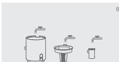
8. Как показано на рис. 8, пылесборник, циклонический цилиндр и его колпак можно очищать водой. Рекомендуется делать это один раз в неделю.
