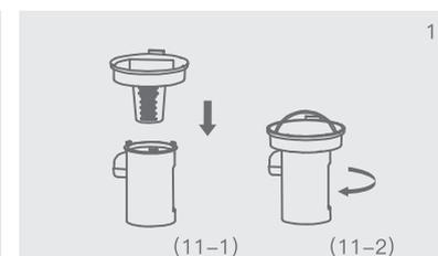
2. Соберите циклонический цилиндр и колпак в соответствии с направлением, показанным на рисунке 11-1. Он должен выглядеть, как показано на рис. 11-2.
