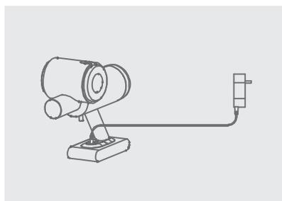
Во время зарядки три светодиодных индикатора будут гореть синим цветом. В зависимости от хода зарядки один светодиодный индикатор будет гореть синим цветом, когда уровень заряда батареи достигнет 35%, два светодиодных индикатора будут гореть синим цветом, когда уровень заряда батареи достигнет 70%, и все три светодиодных индикатора будут гореть синим цветом после того, как уровень заряда аккумулятора достигнет 100%, указывая на то, что зарядка завершена.
