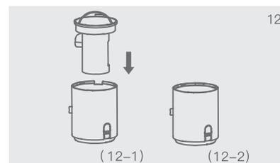
3. Установите собранный циклонический цилиндр в пылесборник в направлении, показанном на рис. 12-1. Он должен выглядеть, как показано на рис. 12-2.
