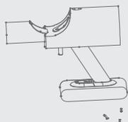
3. С помощью специальной отвертки приподнимите силиконовую прокладку у основания батарейного блока, а затем удалите два винта, как показано на рис. 3.
