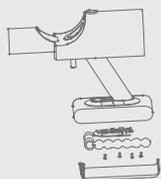
4. Подденьте нижнюю крышку батарейного блока специальной отверткой, удалите 4 винта специальной отверткой и отсоедините проводку, как показано на рисунке 4.
