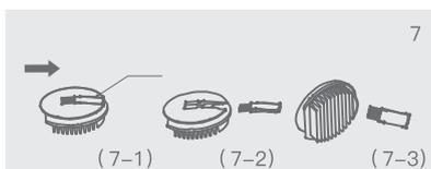
7. Перед чисткой HEPA-фильтра нужно снять щетку для уборки волос (рис. 7-1) так, как показано на рис. 7-2. Вы можете использовать щетку для уборки волос для удаления пыли с HEPA-фильтра, как показано на рисунке 7-3. Рекомендуется чистить HEPA-фильтр один раз в неделю. HEPA-фильтр нельзя мыть водой.
