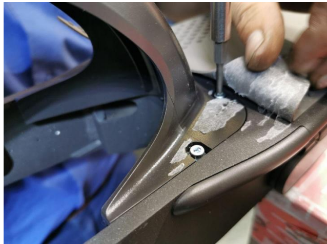
Демонтаж заднего крыла.
