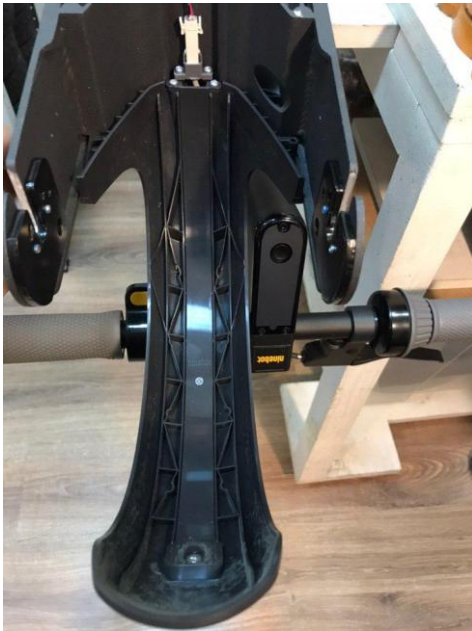
Заднее крыло с защитой провода.
