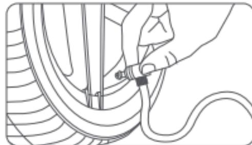
2. 請將快速充氣閥接頭鎖定手柄往內轉90度以確保穩固，此時，空氣應停止洩氣且打氣管已成功連接。
