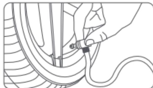
2. 立即将快拔式接头压板向内90°压紧，此时空气不再泄出，气管连接成功。
