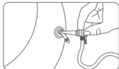
短尺ノズルは膨脹式ベッドに適しています。
